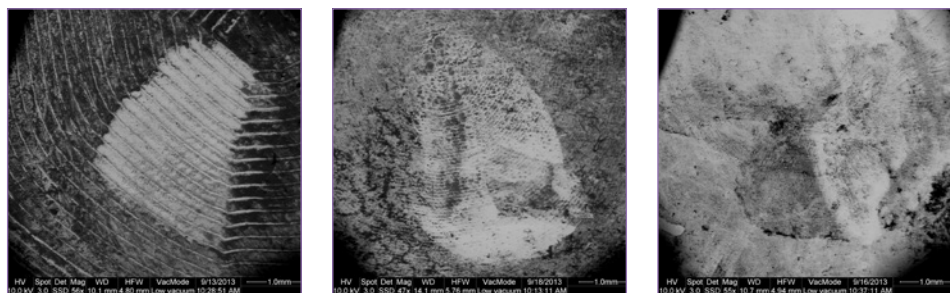
Abb. 2: Die REM-Aufnahmen vor dem Verschleißversuch zeigen die vergleichsweise geringe Furchenbildung bei cara Zirkonoxid (rechts).
