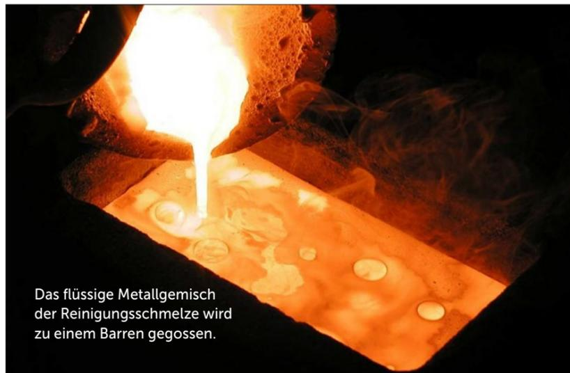
Das flüssige Metallgemisch der Reinigungsschmelze wird zu einem Barren gegossen.
