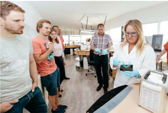
Abb. 2: Sabine Dingens löst das Druckobjekt mit einem Kunststoffschaber vorsichtig von der Bauplattform.
