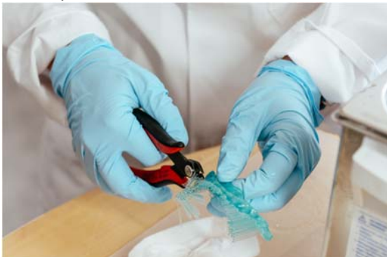
Abb. 3: Vor dem Polymerisieren werden die Stützstrukturen vom Druckobjekt entfernt.
