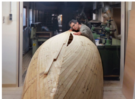
Die Grundform steht: Mit den letzten Leisten schließt sich der Rumpf.
