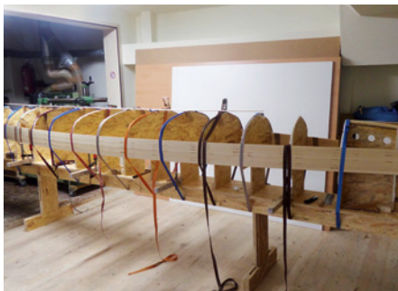
Erste Schritte: Die Helling wird mit den ersten Leisten beplankt.
