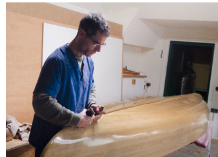
Präzisionsarbeit: Der Außenkiel wird eingepasst.
