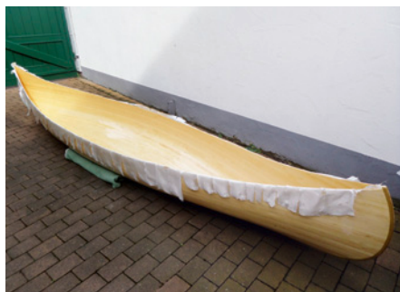
Laminieren: Der Kanurumpf wird innen mit Epoxidharz beschichtet.
